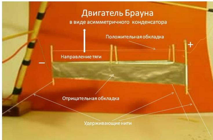
Рис.13. Двигатель Брауна в виде ассиметричного конденсатора
