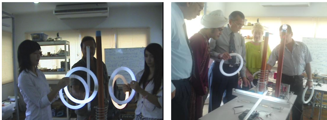
Рис.4. Лабораторные эксперименты по беспроводной передаче электроэнергии
